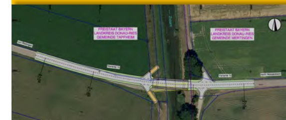
Trassenentwurf Zusambrücke n. Heiðesheim
