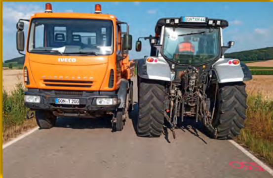
Begegnung LKW—Traktor bei einer Ausbaubreite von 5,50 m
